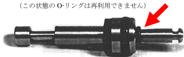
図 4 O-リングが安全弁の根元にある状態 （この状態のO-リングは再利用できません）
